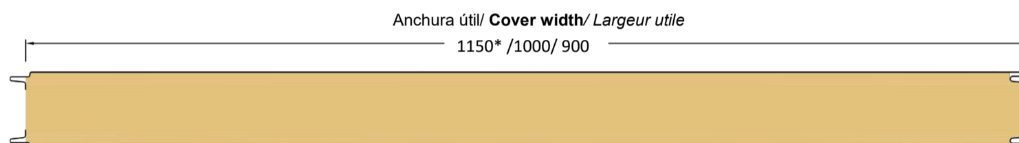
Solape lateral (sistema de fijación vista) Side lap (visible fixation system) Recouvrement latéral (système de fixation visible)
